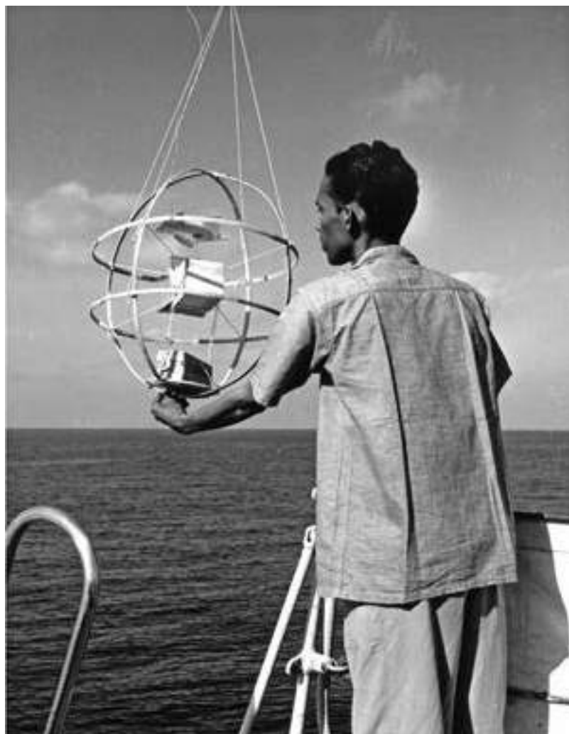
📍 Aparell de transmissió destinat a les observacions meteorològiques, utilitzat en el marc de l'Expedició Internacional de l'Oceà Índic (1959-1965) coordinada per la COI.
